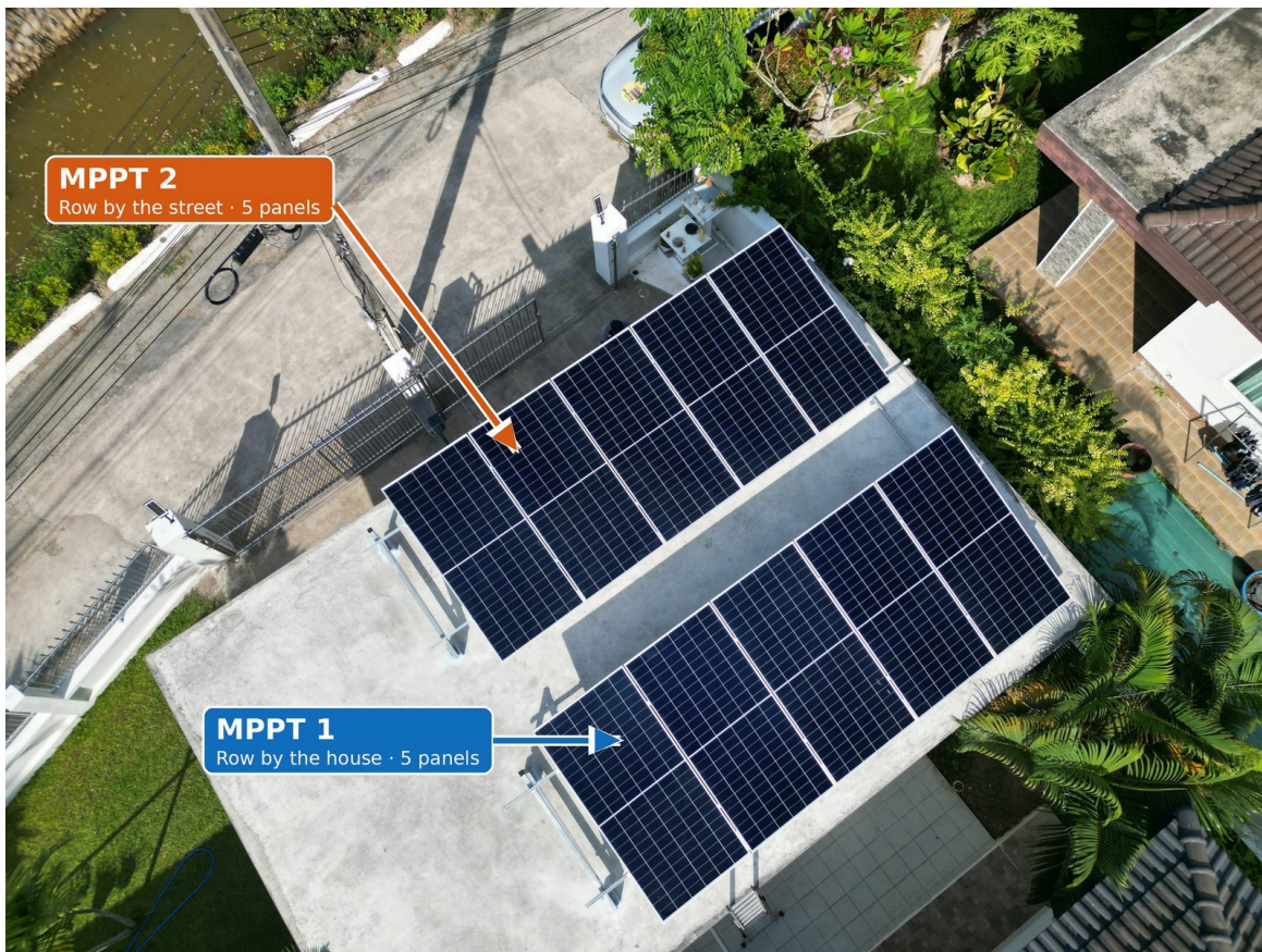
Implantation des chaînes vue du dessus.
