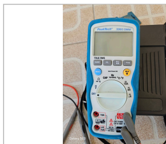
Multimètre numérique TRMS PeakTech 3360 : second appareil pour recouper les mesures.
