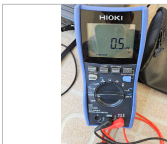
Multimètre numérique TRMS Hioki DT4261 : mesures de tension AC et DC et tests de continuité.
