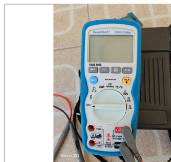
PeakTech 3360 true-RMS digitale multimeter: tweede meter ter controle van de meetwaarden.
