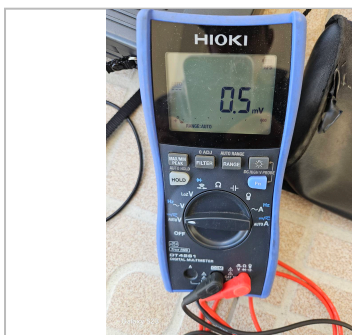
Hioki DT4261 true-RMS digitale multimeter: AC- en DC-spanning en doorgangstests.
