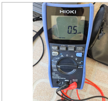
ดิจิทัลดิจิตอล true-RMS รุ่น Hioki DT4261: ใช้วัดแรงดัน AC และ DC และตรวจสอบความต่อเนื่องของวงจร
