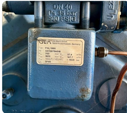
รูปที่ 2 คอมเพรสเซอร์ GEA Bock F14/1366 · 57.4–147.7 ลบ.ม./ชม. ที่ 700–1,800 รอบ/นาที · แรงดันสูงสุด 19/28 บาร์
